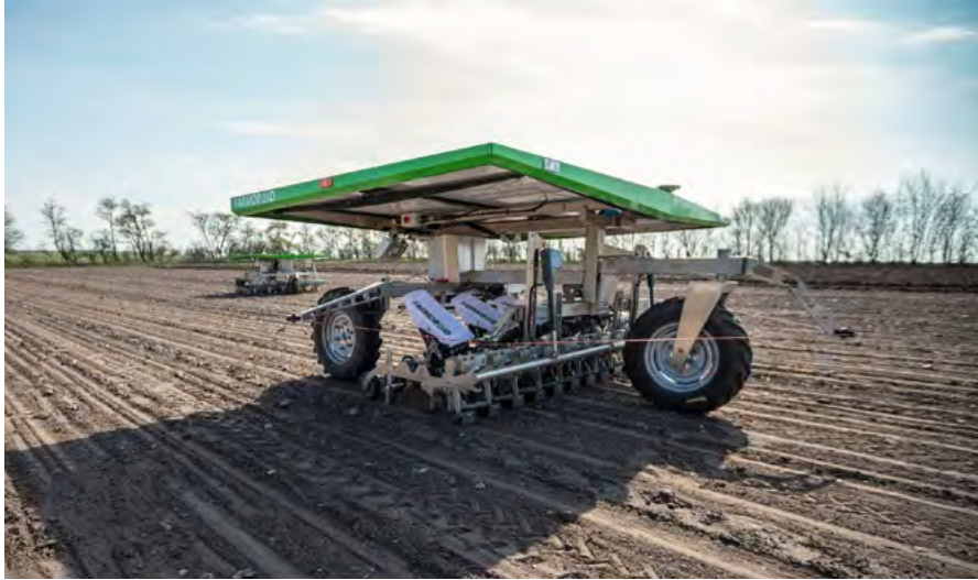
De FarmDroid FD20 zaait het gewas en onthoudt de locatie van ieder zaadje. Zo kan de robot direct gaan schoffelen. Bron: www.farmdroid.com
