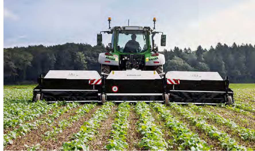
De spotsprayer herkent door algoritmes het verschil tussen een gewas en onkruid. De algoritmes zijn met behulp van AI zelflerend. Bron: www.ecorobotix.com
